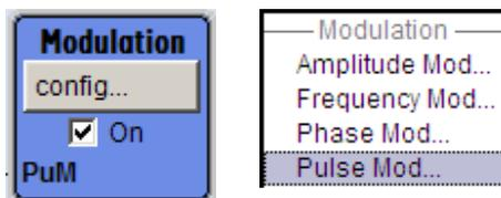
Les signaux de modulation sont configurés dans ce bloc. Les informations d'état du bloc de "Modulation" indiquent la modulation sélectionnée.
