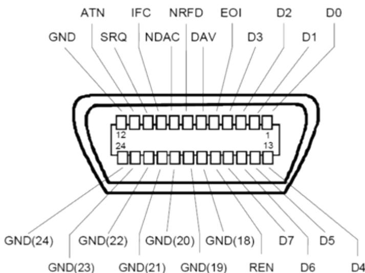
Fig. 1-1 : attribution des broches du bus GPIB
